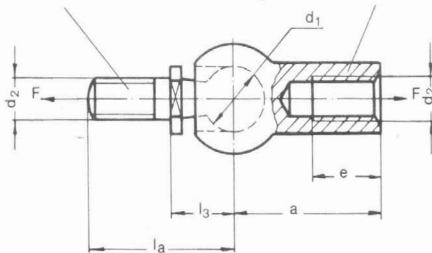
Bezeichnung eines Axialgelenkes mit Kugeldurchmesser 8 mm
